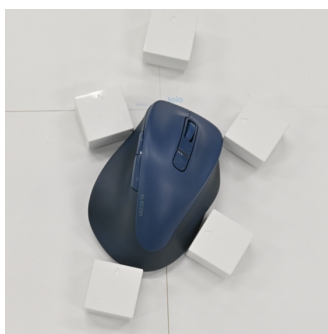
図 9 群ロボットで物体を運搬している様子
