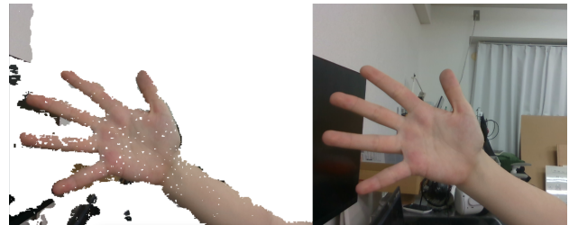
図 5: 1m 以内の物体のみを抽出した様子
