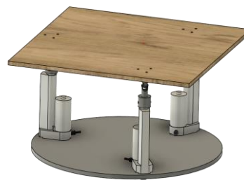
図 5: ふらつき提示シートの機構(3 自由度の平行リンク構造)
