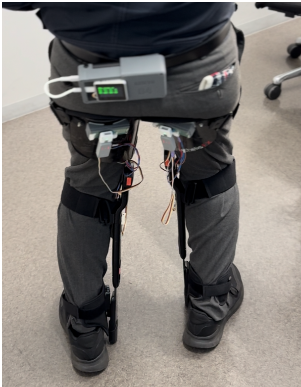
図 2: アシストスーツに取り付けられたセンサおよび制御用 M5Stack
