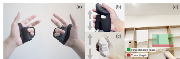
図 1: 親指と人差し指の自由な操作を可能にするフィンガーフリー型触覚デバイス。(a) ハンドトラッキングとの併用による直感的ジェスチャ操作, (b) VR コントローラとの併用による互換性の確保, (c) バーチャル物体の静的な重さを模倣するパッシブ触覚提示, (d) HMD のパススルービュー上で表示される動的な垂直方向の擬似牽引力の提示
