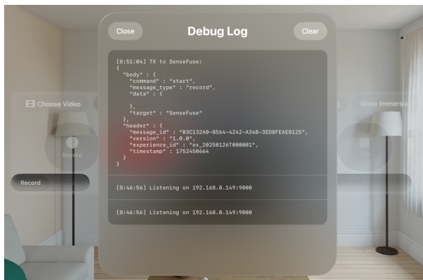
図 5: UDP/JSON メッセージの例。Experium からユニークな Experience ID に紐づけて異種デバイスに対して記録の開始・停止、再生の開始・一時停止・停止のコマンドを送信する。
