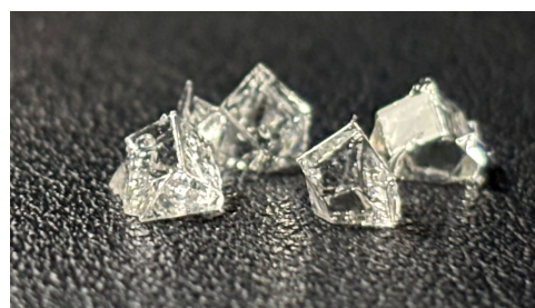
図2: 単一コーナーキューブ構造の飴製再帰性反射材
