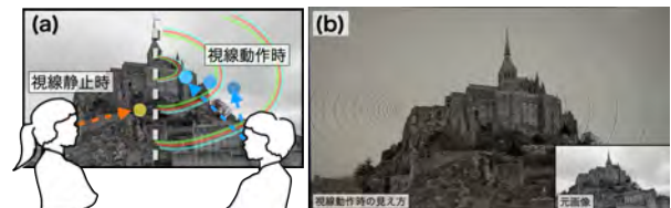
図 1: 提案手法概要: (a) 手法コンセプト: (左) 視線静止時は元画像が見える (右) 視線動作時には元画像上に視線誘導パターンが見え、ユーザの視線が誘導される。(b) カメラを動かしながら本手法を用いた表示を撮影した様子。
