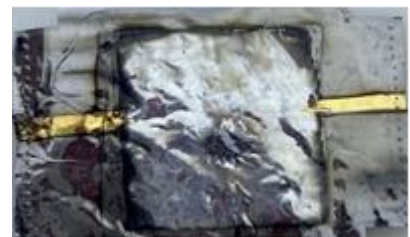
図 1： 薄膜樹脂型の触覚デバイス：センサーとアクチュエータの両方の機能を有する
