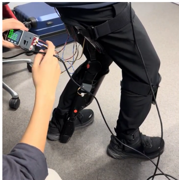
図 1: アシストスーツ アルケリス FX を用いた立位着座姿勢
