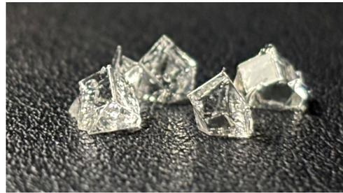
図2: 単一コーナーキューブ構造の鉛製再帰性反射材
