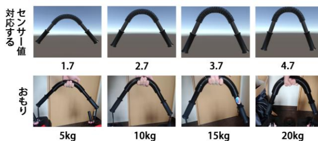
図 4: シミュレートしたアームバーと実際のアームバーの曲がり具合の比較結果
