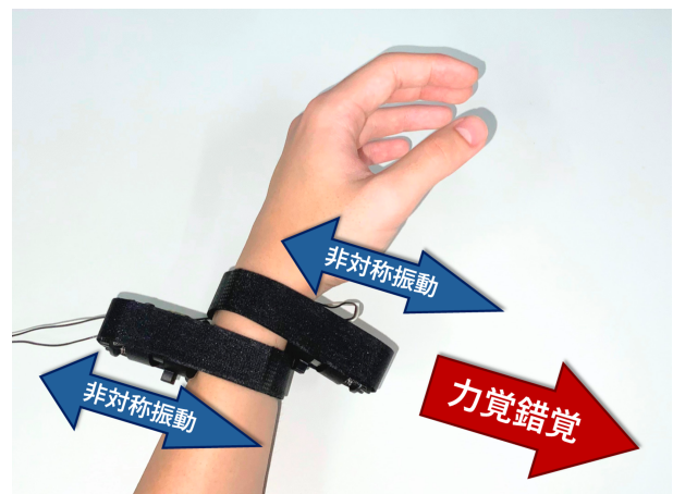
図 1: 腱への非対称振動刺激を用いた力覚提示手法
