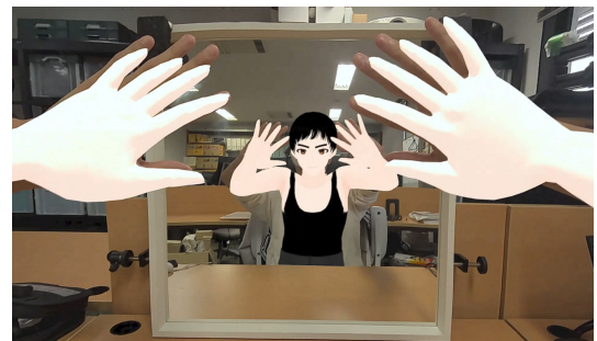
図 1: ビデオシースルー HMD によるユーザの実身体と実鏡越しの鏡像身体のアバター化. ユーザの実身体と鏡像身体がアバターの表示からはみ出して見えてしまう課題がある.
