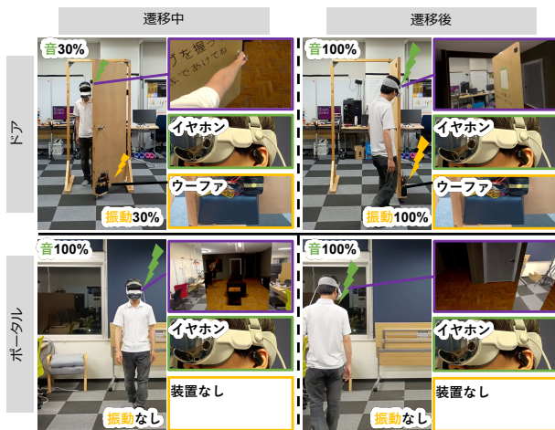
図 2: (左上) ドア手法の場合にドアを開けるにつれて音と振動が強まる。(右上) ドア手法の場合にドアを完全に開けると音と振動が最大になる。(左下) ポータル手法の場合に振動はなく音は常に最大となる。(右下) ポータル手法の場合に常に実環境が表示される。
