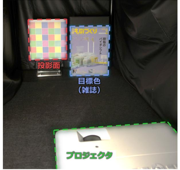
図 1: 実験セットアップ。被験者はプロジェクタの上部に視点を固定するようにして、投影画像と雑誌を観察する。
