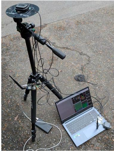
図 3: RTK-GNSS ベースステーション
