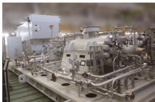
図 1 荏原製作所の高圧ポンプ
