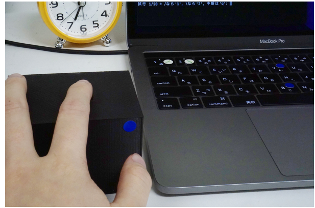
図 3: 実験セットアップ。実験参加者は左示指の指腹を刺激提示部に置き、右手でキーボードを操作して回答する。
