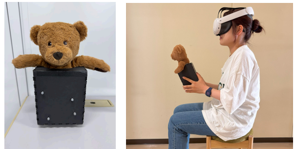
図 1: ぬいぐるみ型コントローラ (左) と操作する様子 (右)
