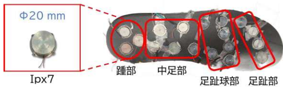
図1 片足の実験用の靴とモータ配置
