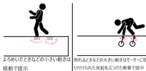
図 7: 相手の動きを表す機構の動作の様子
