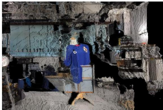
図 5d. 撮影画像と視差画像から生成したプロジェクタ光学中心視点の画像
