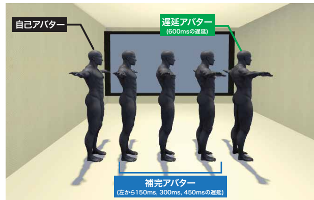
図 1: 補完アバターは自己アバターと遅延アバターの間に配置され、遅延アバターまで運動が伝播する様子を提供する。
