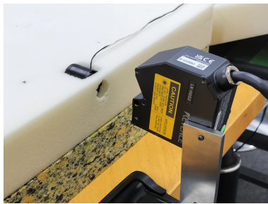
図8: レーザ変位計による変位と加速度の測定
