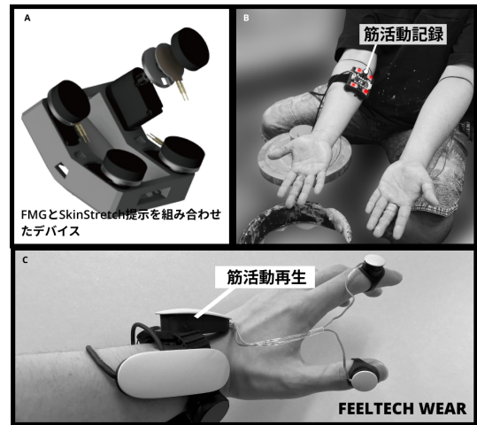
図 2: システム構成 (A)FMG と回転の皮膚せん断刺激を統合した計測・調整用デバイス (B) 計測・調整用デバイスを装着する様子 (C) 刺激提示用デバイスを装着する様子
