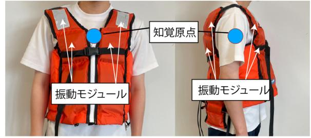
図 3: 胴体装着型の振動デバイス
