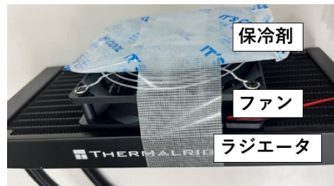
図5：ラジエータ部分の構成
