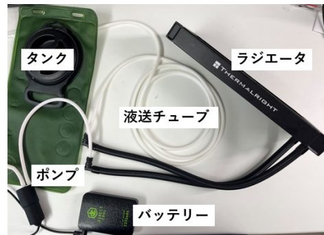
図4：試作した水冷装置
