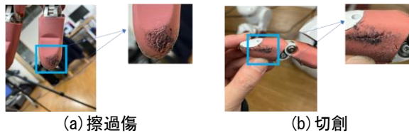
図 1: AIREC ハンドの損傷
