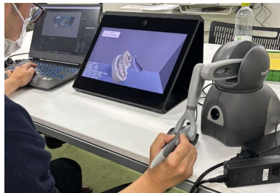
図 1: 支台歯形成シミュレーターの動作の様子
