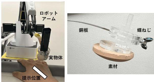
図 3: (左) ロボットアームと提示位置の拡大図。(右) ロボットの先端構造。銅板により圧力の調整が可能。
