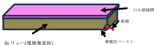
図1: 作製した静電触覚ディスプレイ
