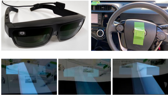
図 1: AR グラスによるハンドル操作情報の提示
