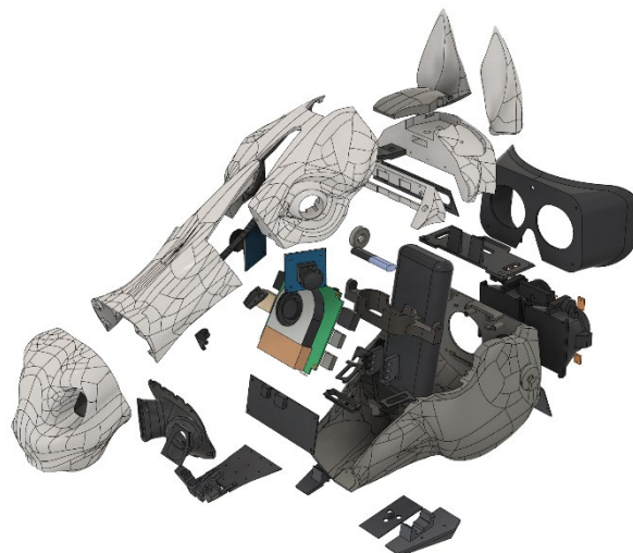
図 5 CAD 上で分割した U-HMD
