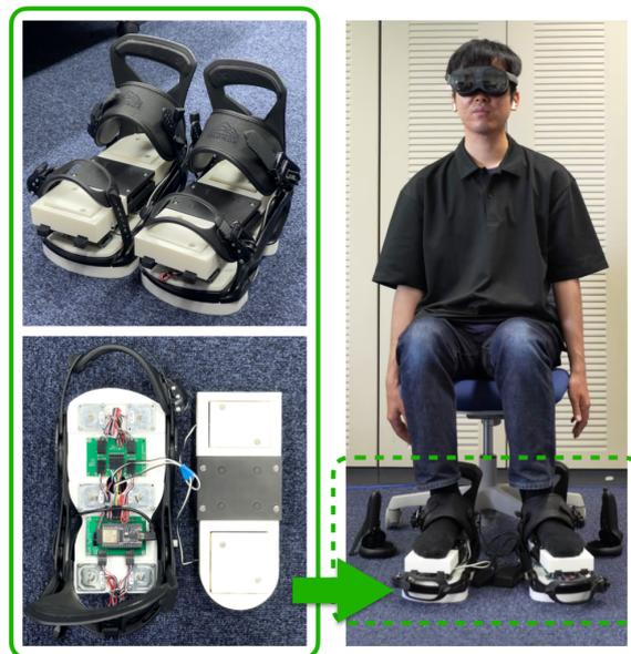
図1: HMDとワイヤレス足裏入力振動デバイスを装着したユーザーの全体構成。左上: 足裏デバイスの外観。左下: 振動子ユニットを外し、圧力センサと制御基板が露出した内部構造。裏面に振動子を駆動するアンプ基板を配置する。
