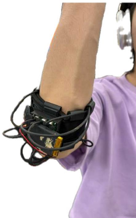
図 5: FMG の取り付け図
