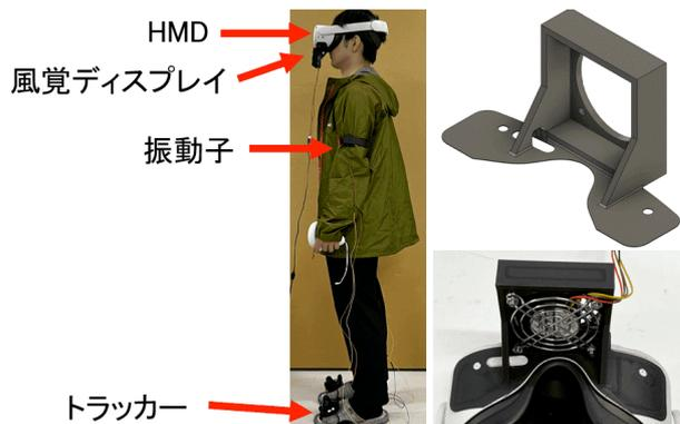
図 2: 左 システムの全体図, 右上 風覚ディスプレイ固定用治具の概形, 右下 風覚ディスプレイと治具
