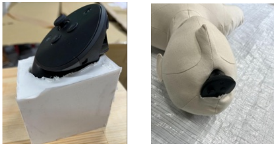
(a)コントローラーの型取 (b)人形頭部への装着
