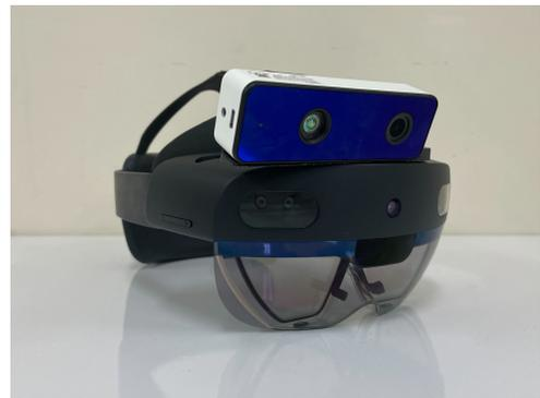
図 3: 使用したデバイス。HMD の上部に RGB-D カメラを固定している。
