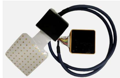
図 1 多点筋電気刺激装置。10 mm 間隔で 8×8 個並ぶ電極を用いた。
