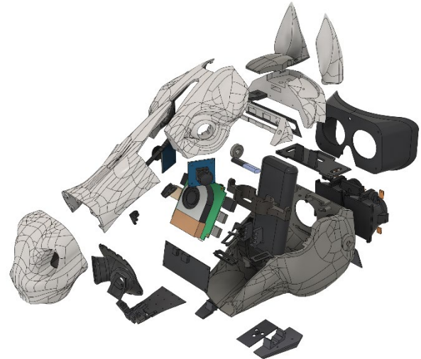
図 5 CAD 上で分割した U-HMD
