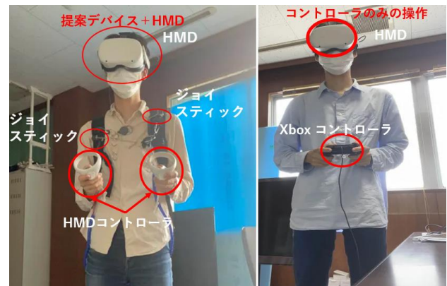
左：図3(a) 提案デバイスを用いたリュックの装着方法
