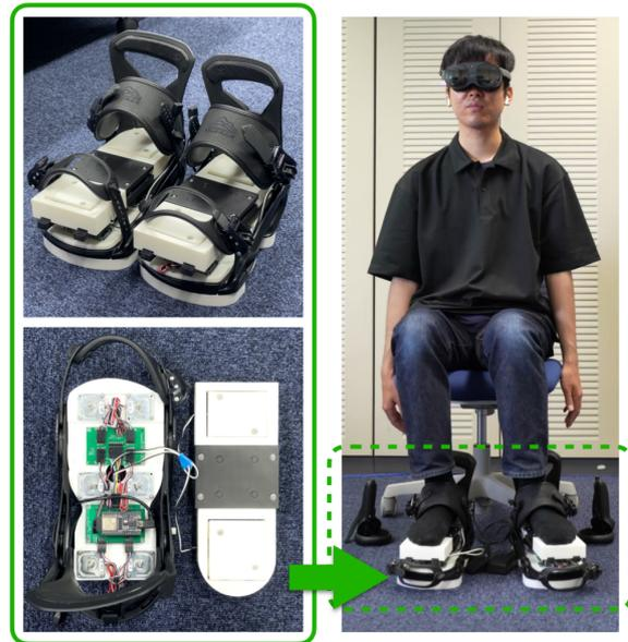
図 1: HMD とワイヤレス足裏入力振動デバイスを装着したユーザーの全体構成。左上: 足裏デバイスの外観。左下: 振動子ユニットを外し、圧力センサと制御基板が露出した内部構造。裏面に振動子を駆動するアンプ基板を配置する。
