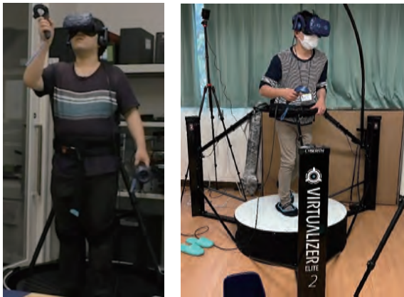
図 1: 歩行型仮想旅行システムのハードウェアの外観。(左)KATVR 社 Kat Walk MiniS を用いたプロトタイプ 1, (右)Cyberith 社 Elite-II を用いたプロトタイプ 2
