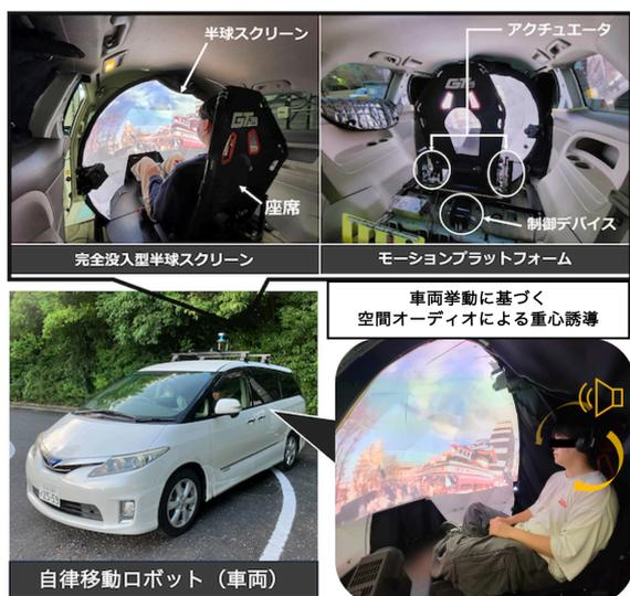
図 2: XR キャビン（自動走行システム）と車内空間オーディオ情報提示による重心移動（提案手法）
