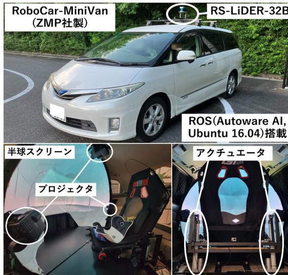
図 1: XR キャビンの概要図 (自動運転車 (上), 没入型の VR 映像提示 (左), モーションプラットフォーム (右))
