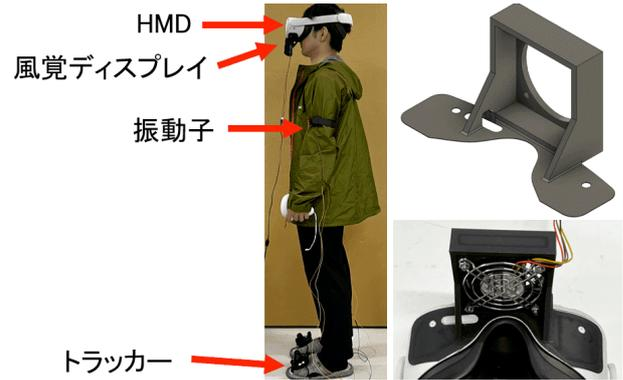
図 2: 左 システムの全体図, 右上 風覚ディスプレイ固定用治具の概形, 右下 風覚ディスプレイと治具
