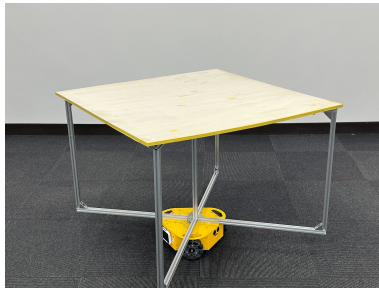
図 1: 利用したオムニホイール型ロボットに、触覚提示部として木板を取り付けた様子の写真。
