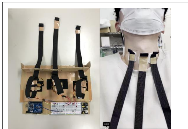
図 1: 「Grutio Hydra」のプロトタイプ(左図)、装着例(右図)。左図にあるように装置には 3 本の紐があり、上側に接着電極を取り付ける。その後、右のように接着電極を首に貼ることで、紐が引っ張られると同時に首の皮も引っ張られて飲み込む感覚を味わうことができる。
