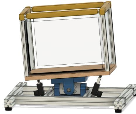
図8: 傾斜提示装置の外観
