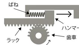
図 7: 衝撃提示装置の機構
